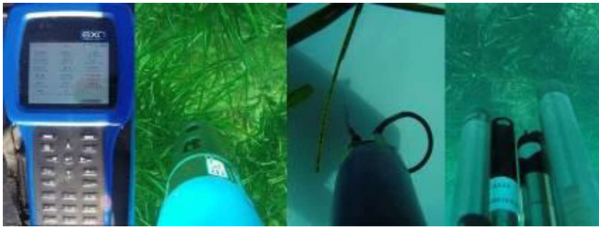
Fotografía 3. Sonda EXO2 y unidad de mano
