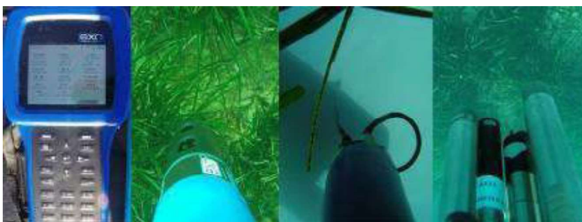
Fotografía 3. Sonda EXO2 y unidad de mano
