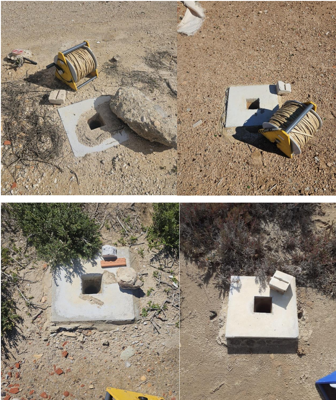
Figura 2. Piezómetros de control durante la campaña de campo de marzo de 2025: arriba a la izquierda (P5), arriba a la derecha (P6), abajo a la izquierda (P7) y abajo a la derecha (P8).
