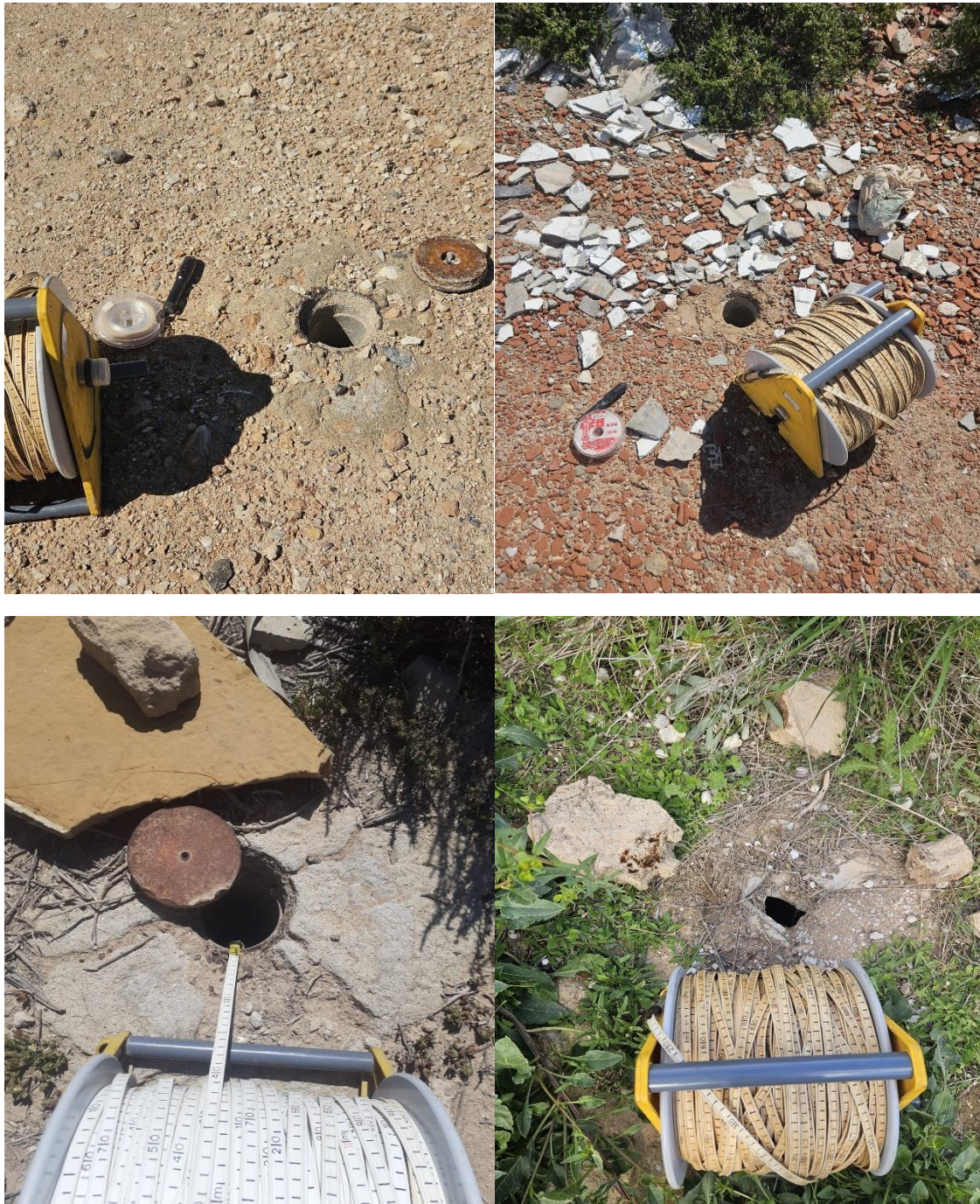
Figura 1. Piezómetros de control durante la campaña de campo de marzo de 2025: arriba a la izquierda (P1), arriba a la derecha (P2), abajo a la izquierda (P3) y abajo a la derecha (P4).
