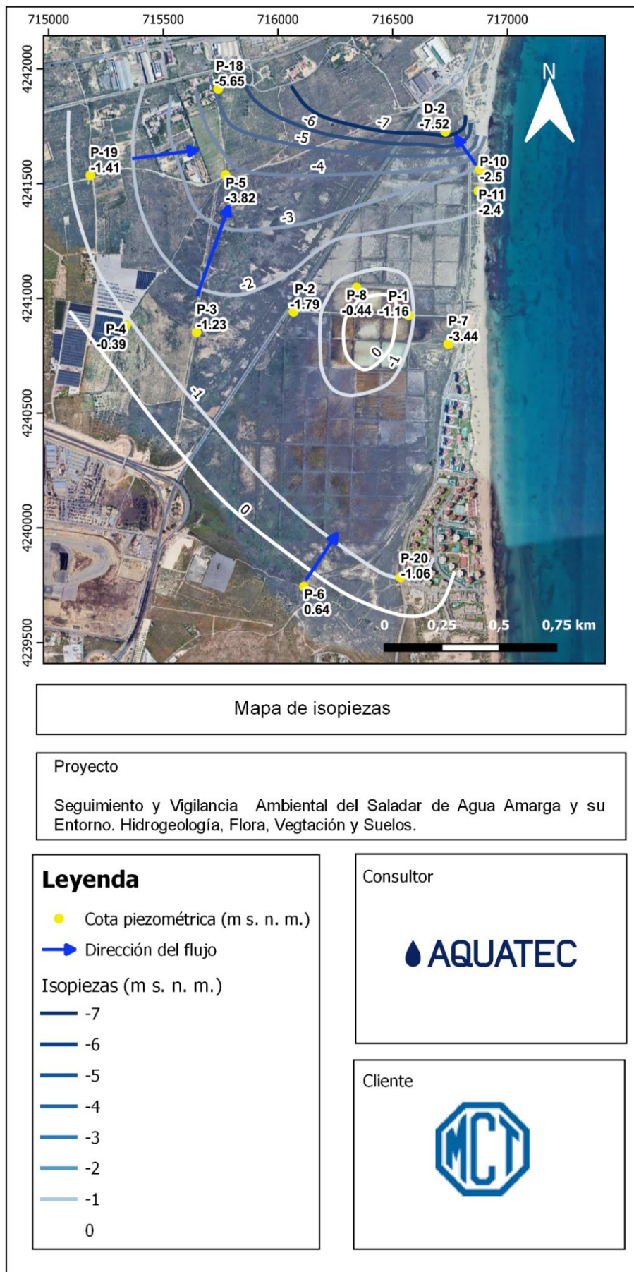
Figura 21. Mapa de isopiezas elaborado con los datos de la campaña de campo de marzo de 2025.
