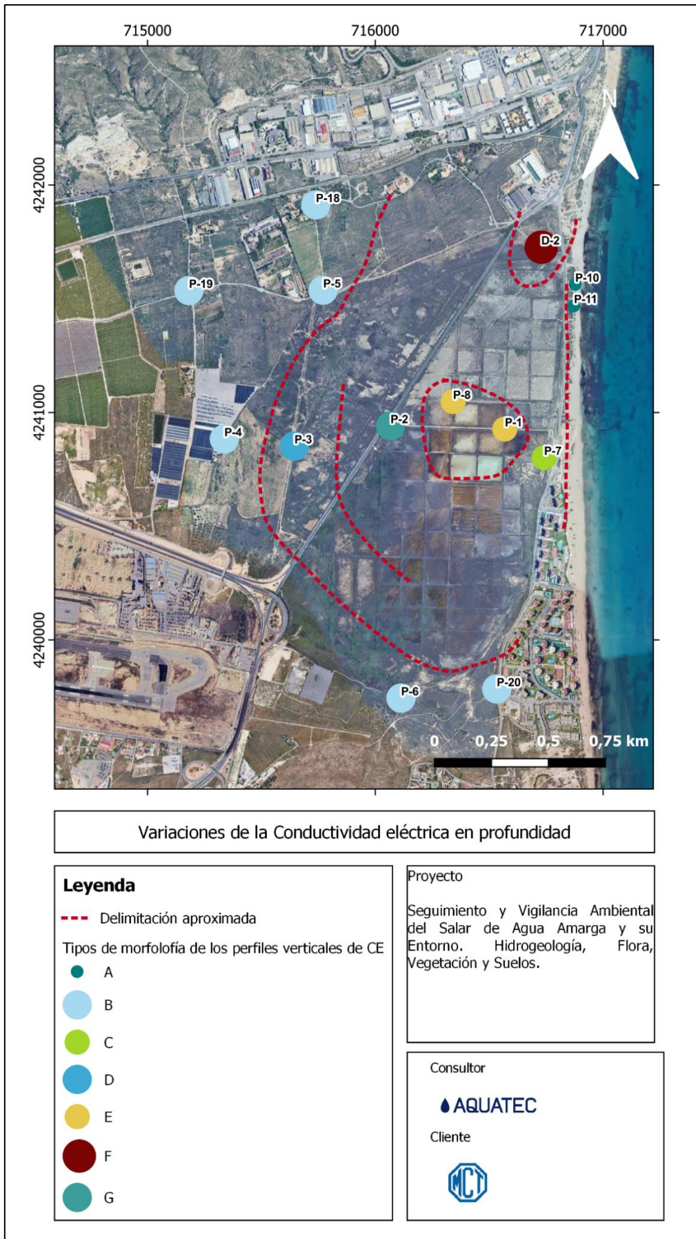
Figura 30. Clasificación de los piezómetros de control en función del comportamiento de la conductividad eléctrica a lo largo del perfil vertical, datos de la campaña de enero – marzo de 2025.
