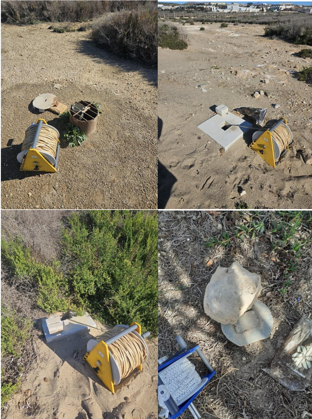
Figura 3. Piezómetros de control durante la campaña de campo de marzo de 2025: arriba a la izquierda (D2), arriba a la derecha (P10), abajo a la izquierda (P11) y abajo a la derecha (P18).
