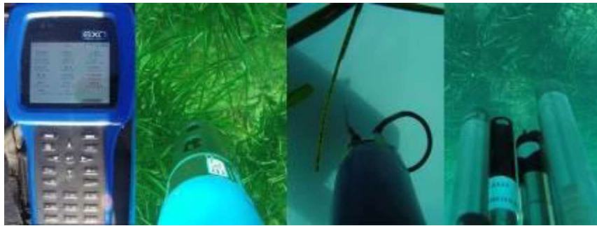
Fotografía 3. Sonda EXO2 y unidad de mano
