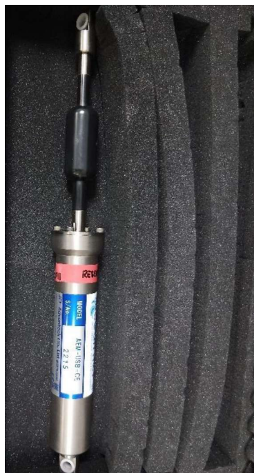
Fotografía 2. Correntímetro JFE AEM-USB-CE.
