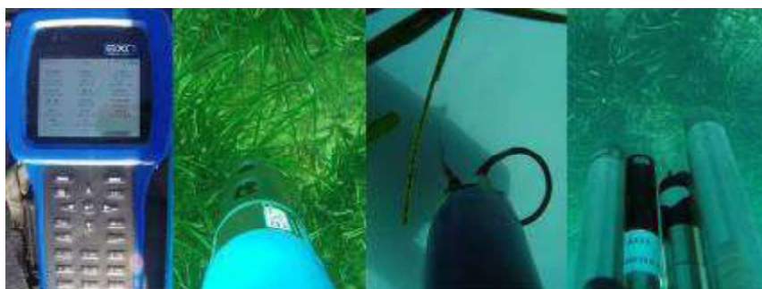
Fotografía 3. Sonda EXO2 y unidad de mano
