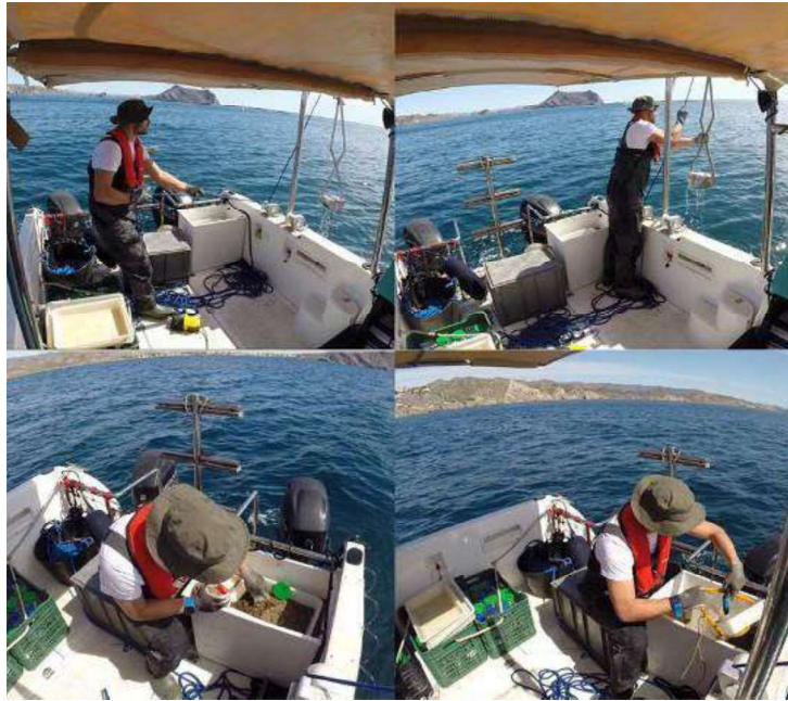
Ilustración 1. Ejemplo toma de muestras sedimentos y macrofauna bentónica. Draga Van Veen.
