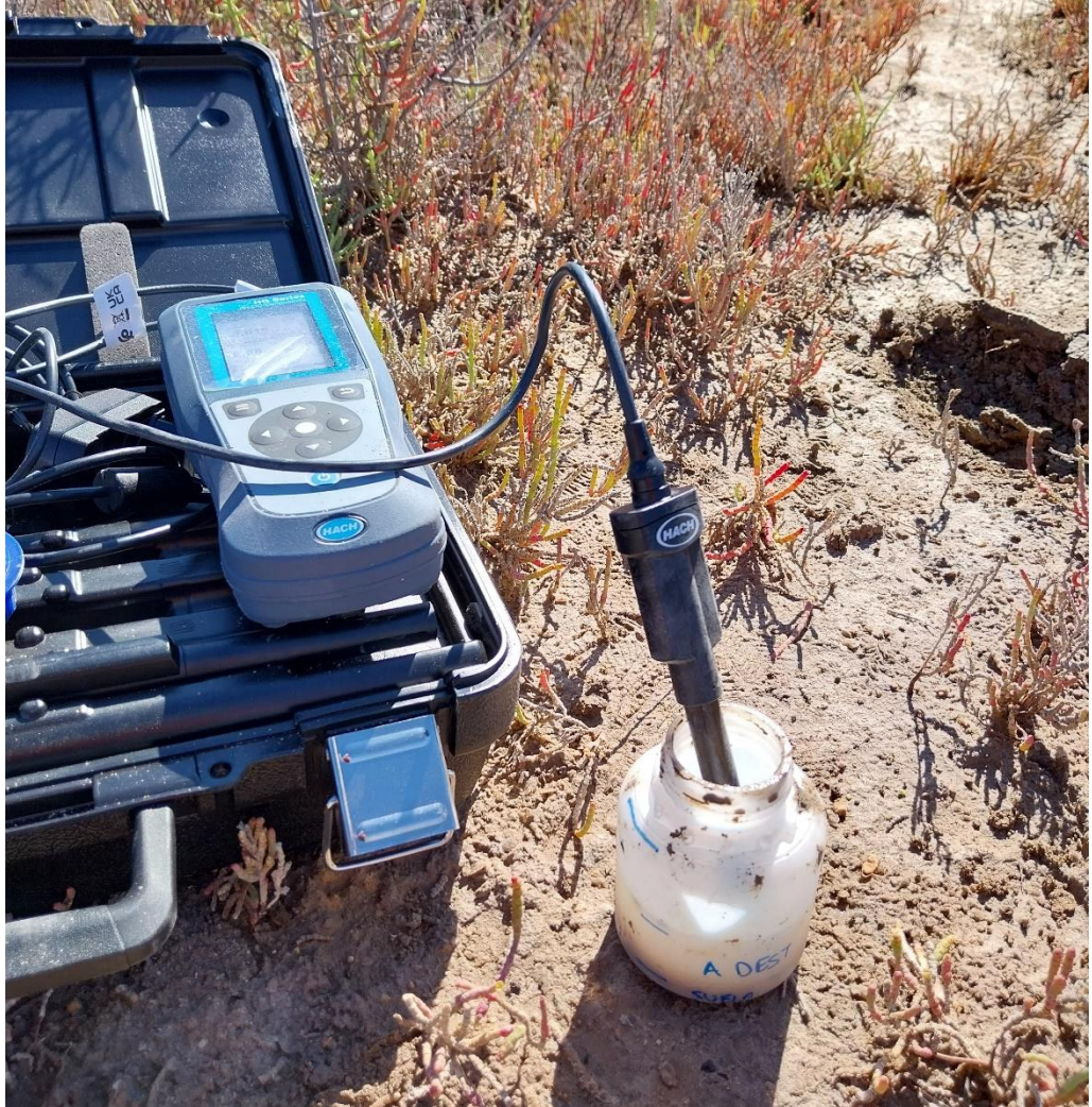
Figura 8. Lixiviación in situ para determinación de parámetros fisicoquímicos en el punto de muestreo S39.
