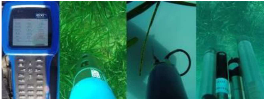
Fotografía 3. Sonda EXO2 y unidad de mano
