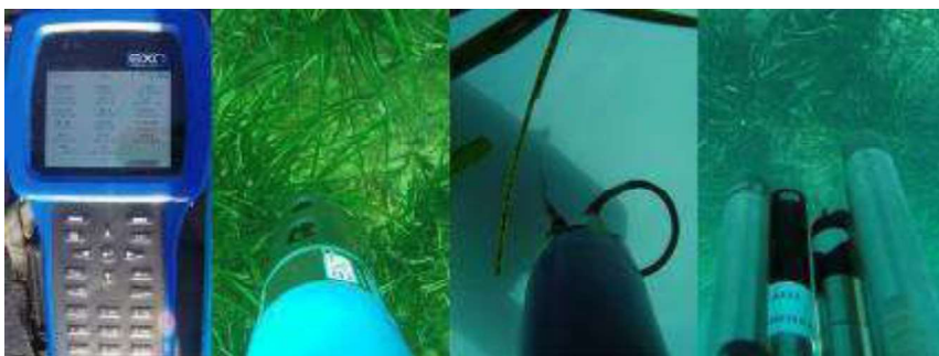
Fotografía 4. Sonda EXO2 y unidad de mano.
