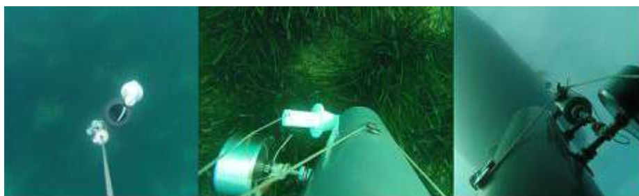
Fotografía 5. Botella oceanográfica tipo Niskin.
