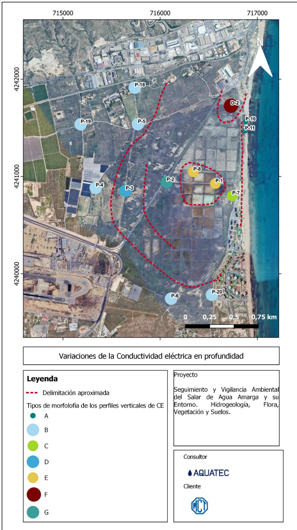
Figura 32. Clasificación de los piezómetros de control en función del comportamiento de la conductividad eléctrica a lo largo del perfil vertical.
