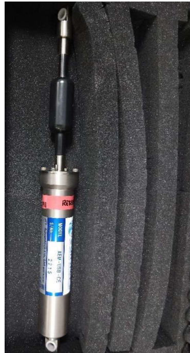
Fotografía 2. Correntímetro JFE AEM-USB-CE.
