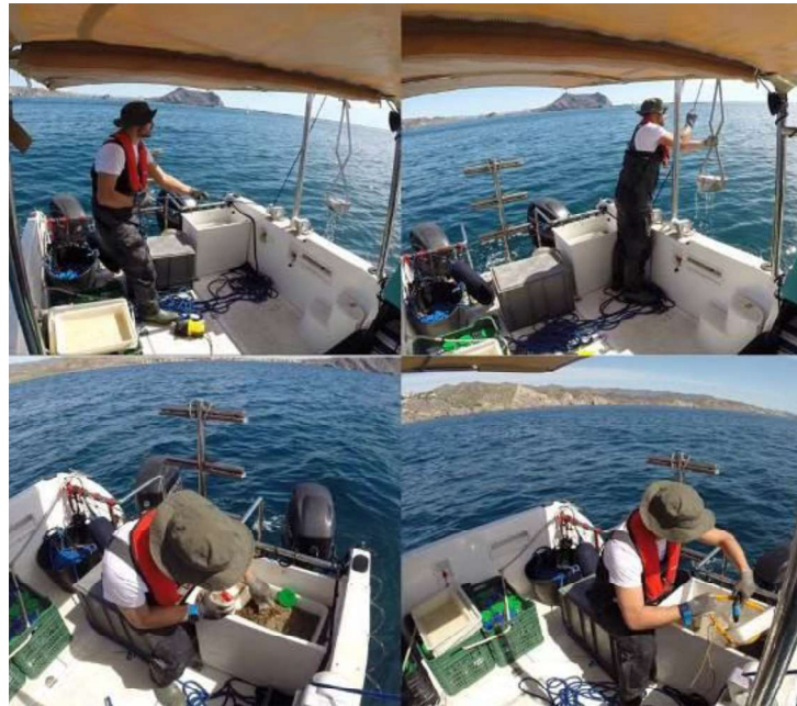
Ilustración 1. Ejemplo toma de muestras sedimentos. Draga Van Veen.
