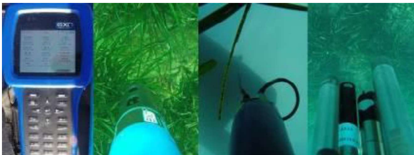
Fotografía 3. Sonda EXO2 y unidad de mano.
