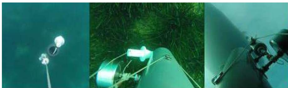
Fotografía 5. Botella oceanográfica tipo Niskin.
