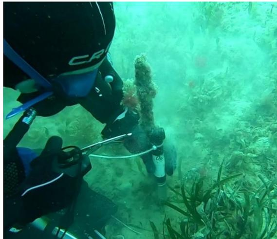
**Imagen 1:** Sensor de Conductividad y Temperatura (CT) usados en el estudio.
