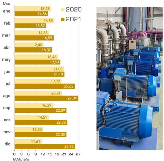
Figura 54. Comparativa del consumo de energía interanual en los años 2020 y 2021. En la imagen sistema de bombeo del agua filtrada (IDAM Alicante I).
