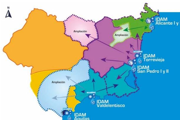
Figura 31. Ámbito geográfico de distribución del agua desalada en el sistema de suministro de la MCT: Actual (colores fuertes) y futuro (zonas de ampliación, colores degradados).
