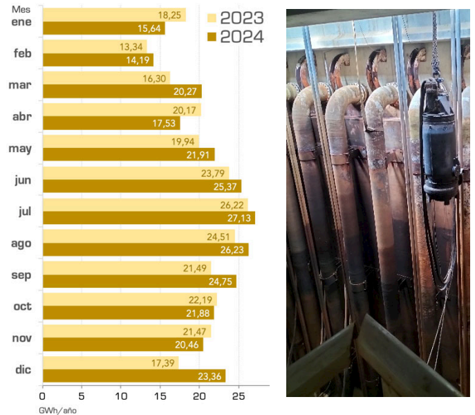
Figura 56. Consumo energético de las desalinizadoras que explota directamente la MCT. Comparativa Años 2023-2024. (En la Imagen: Extracción bomba agua del mar en la IDAM de Alicante).
