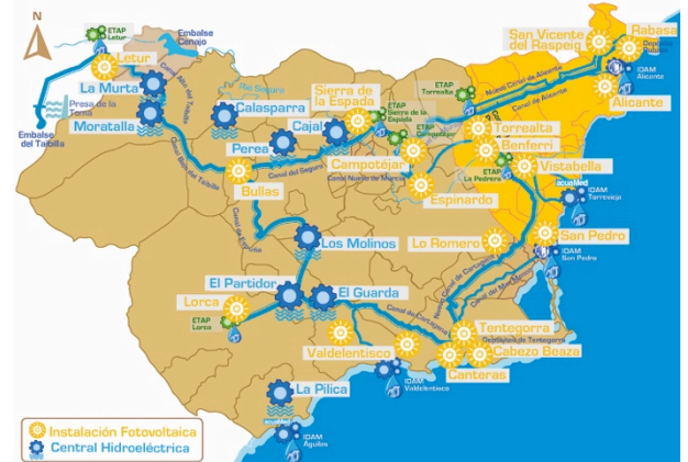
Figura 63. Instalaciones de Producción eléctrica. Centrales hidroeléctricas e instalaciones fotovoltaicas.
