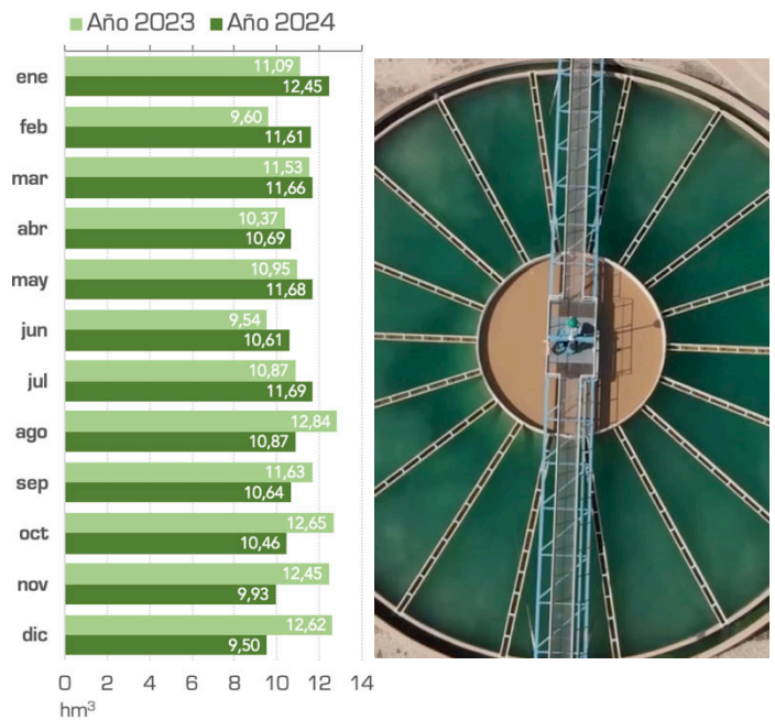
Figura 40 Análisis comparativo interanual de los volúmenes potabilizados en las ETAP de la MCT para el suministro de abastecimiento en los años 2023 y 2024. Datos en hm 3 . En la imagen, decantadores de la ETAP de Torrealta.
