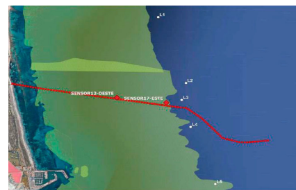
Imagen 21. Representación gráfica de las sondas instaladas en el mar, para el control de la salinidad y temperatura del vertido de salmuera
