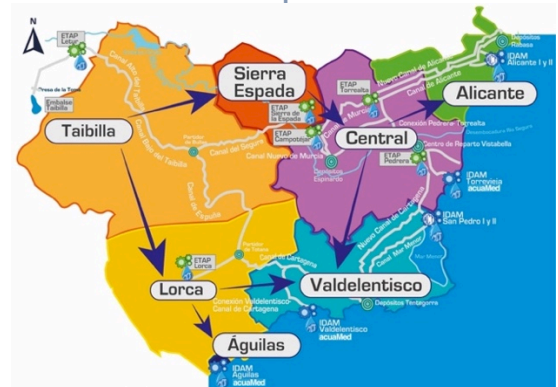
Figura 10. Traslados de recursos entre áreas de influencia de centros de producción. Funcionamiento del sistema actual.
