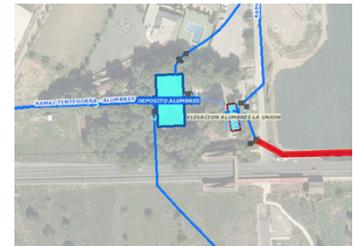
La conducción existente, a pesar de su larga vida en funcionamiento, se encontraba en buen estado pero su diámetro era insuficiente y presentaba problemas de rotura por presión, debido a instalación de tres bombas (2+1) en la elevación de Alumbres, tal y como se ha comentado en el párrafo anterior. Dicha tubería no era capaz de resistir la presión cuando funcionaban dos de ellas en paralelo, por lo que era precisa la ampliación del abastecimiento existente.
