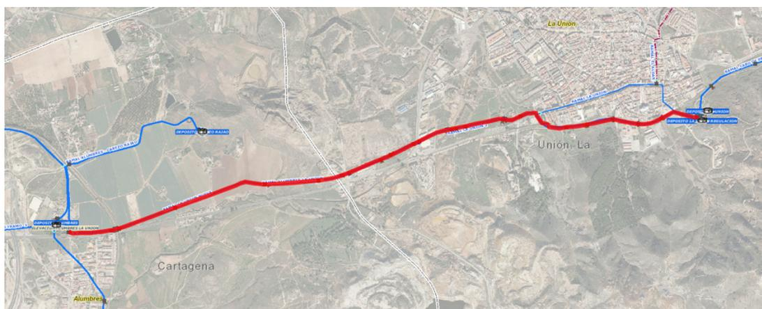
Esta tubería ejecutada para la ampliación parcial del ramal del Abastecimiento a La Unión parte de una arqueta junto a la carretera de Roche y la N-332. En los siguientes 250 m la conducción discurre paralela a dicha nacional..
