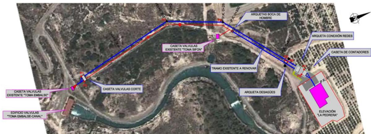
Las obras han consistido fundamentalmente en la instalación de una nueva tubería de acero de diámetro exterior 1.524 mm (60") en paralelo con la existente de longitud 478 ml; también se ha renovado con igual tubería de acero un tramo de 150 ml. de conducción existente formada con tubería de hormigón con camisa de chapa Ø1500 que presentaba deficiencias y roturas continuadas, todo ello para quedar garantizado el suministro hidráulico a la ETAP La Pedrera.
