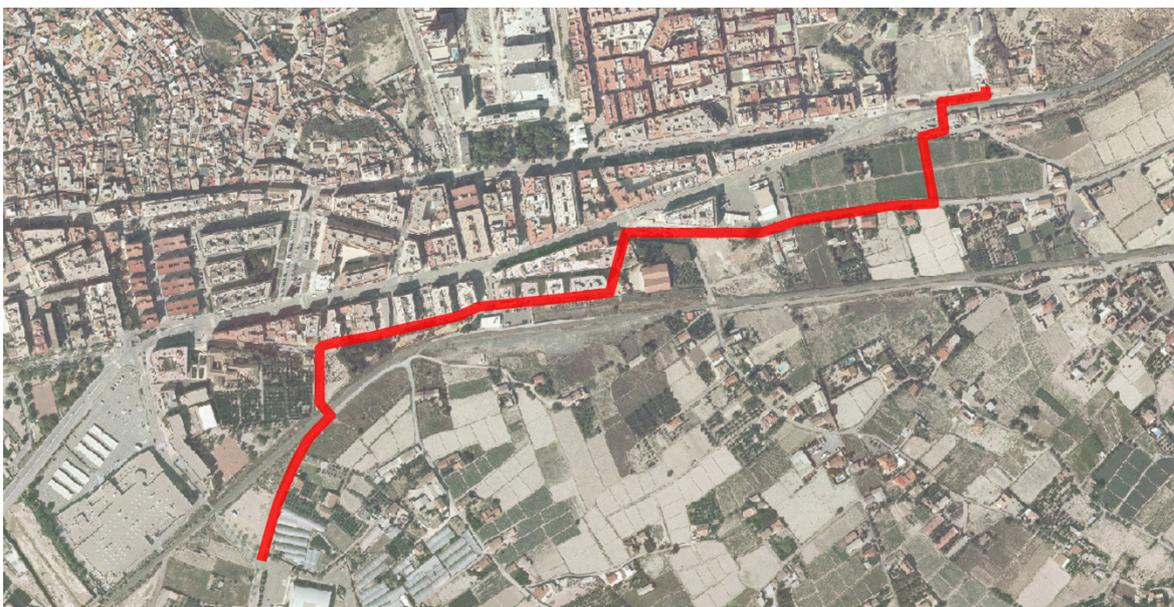
La tubería parte de la Avenida Europa, entroncando con la tubería actual de D.N. 500 mm de camisa de chapa, que proviene del depósito de agua de la Mancomunidad de los Canales del Taibilla. A continuación discurre por terreno privado de huerta unos metros, paralela a una tubería de función dúctil de D.N 500 propiedad de la Mancomunidad de los Canales de Taibilla en servidumbre, para
