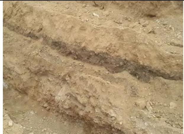
Tramo P.K. 2350- P.K. 2700. Aspecto de la sedimentación natural formada por una terraza aluvial (arenas, gravas y cantos), con niveles intercalados oscuros con abundante materia orgánica de origen natural.
