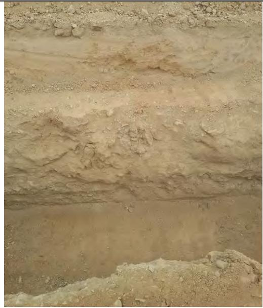
Tramo P.K. 2350- P.K. 2700. Sedimentación natural de textura arenosa con bloques angulares de yeso y calizas.
