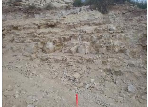
Detalle estratigráfico del camino de acceso al depósito 10.000 m3, con calcarenitas y margas estratificadas en tablas.
