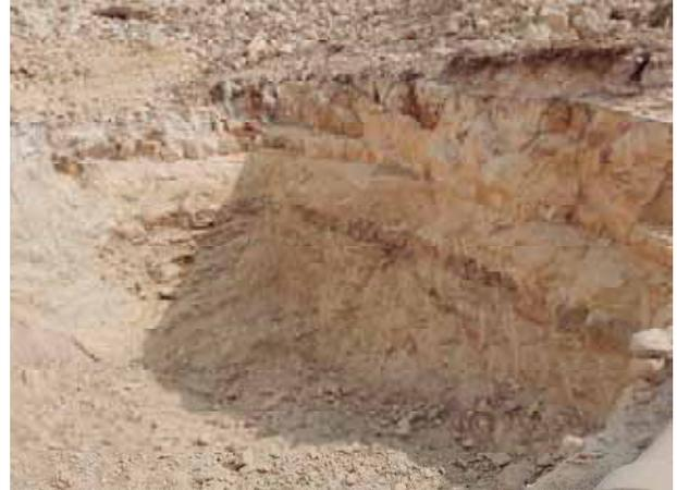
Detalle de la estratigrafía formada por margo-calizas tableadas.
