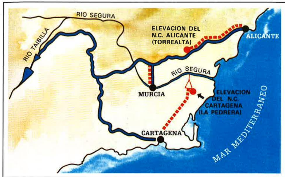
Los Nuevos Canales de Alicante y Cartagena inician su recorrido en cotas superiores a las de los orígenes de las aguas que han de transportar (canal de la margen izquierda y Embalse de la Pedrera), siendo necesario recurrir a la construcción de las elevaciones de Torrealta y la Pedrera que impulsarán los caudales correspondientes a los canales citados.
