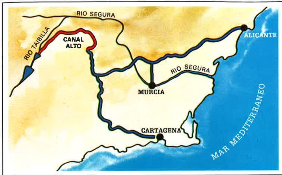
Se inicia en la Presa de Toma con dirección N.E., rodea la Sierra del Taibilla y finaliza en el rápido de Moratalla con dirección S.E., después de un recorrido de 58 km. Destacan en su trazado los túneles de la Murta (3 km.) y del Roble (3km.), el sifón de Socovos (2 km.) y los rápidos de la Murta (41 m.) y de Moratalla (96 m.) De él derivan los ramales de abastecimiento a los municipios de Férez y Socovos.
