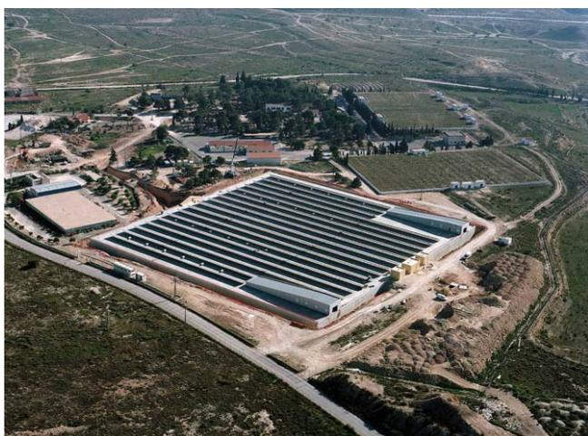
*Figura 58. Imagen de la instalación fotovoltaica en la cubierta del depósito de Rabasa (Alicante).*
