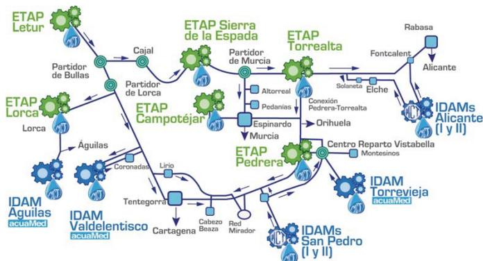
Figura 64. Esquema general de funcionamiento del Sistema Hidráulico de producción y distribución de la MCT. Fuente: "Plan de Emergencia ante Situaciones de Sequía". Elaboración propia.
