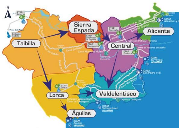
Figura 72. Traslados de recursos entre áreas de influencia de centros de producción. Funcionamiento del sistema actual.
