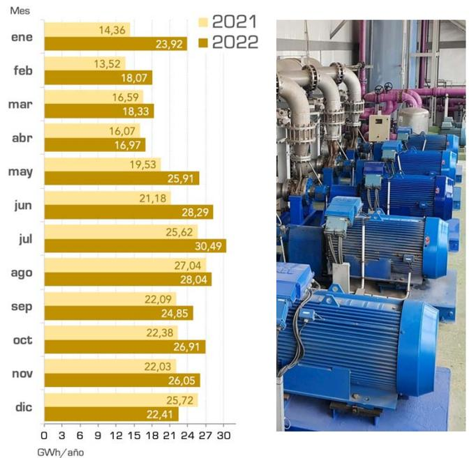
Figura 54. Comparativa del consumo de energía interanual del sistema hidráulico de la MCT en los años 2021 y 2022. (En la imagen sistema de bombeo del agua filtrada (IDAM Alicante I.).)
