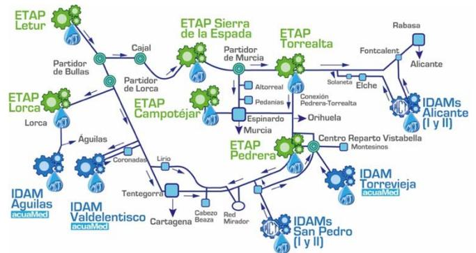
Figura 8. Mapa y Esquema general de funcionamiento del Sistema Hidráulico de producción y distribución de la MCT. Fuente: Plan de Emergencia ante Situaciones de Sequía (año 2020).
