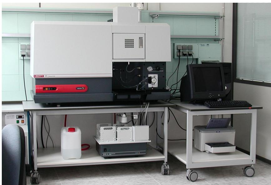
**ESPECTRÓMETRO DE EMISIÓN DE PLASMA (AXIAL, SECUENCIAL) – LABORATORIO CENTRAL**
