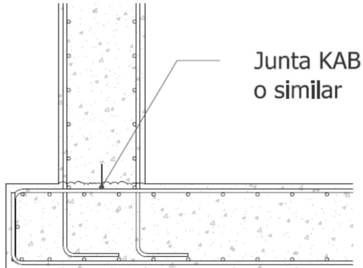
Nudo empotrado con armadura pasante en junta de construcción en alzado y junta de estanqueidad tipo KAB o similar.
