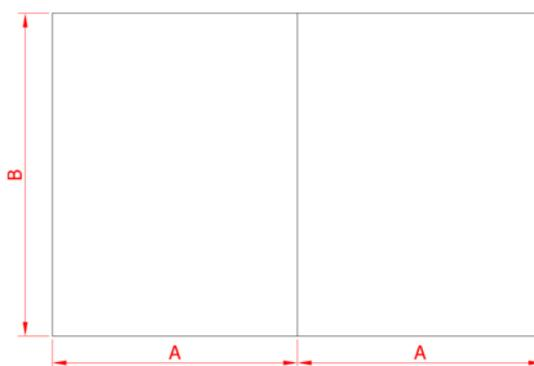
Incluso podría disminuirse algo más la dimensión B, ya que el muro divisorio está sometido a empujes del agua en los dos paramentos y tiene un coste mayor; pero disminuiría por otro lado la circulación del agua.
